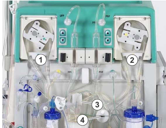
Abb. 4-9 Einlegen der Pumpensegmente
