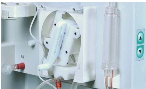
Fig. 9-12 Manovella sulla pompa sangue
