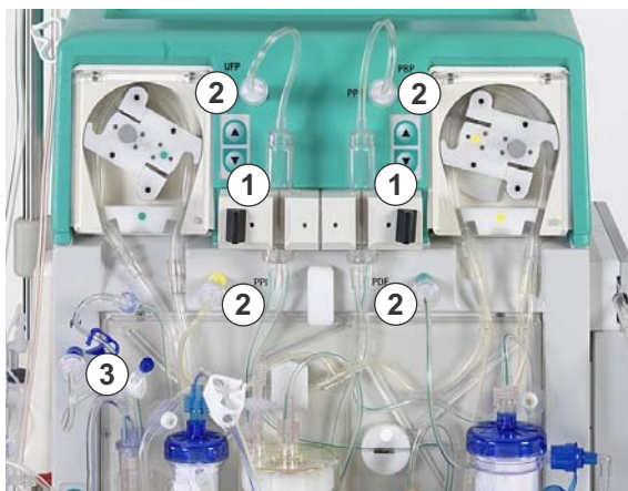
Fig. 4-10 Installazione delle camere
